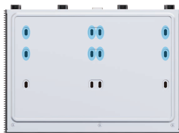
Για την εγκατάσταση σκληρού δίσκου 3,5 ιντσών
