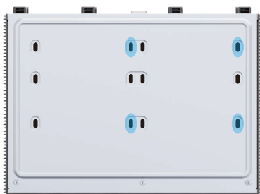
Για την εγκατάσταση σκληρού δίσκου 2,5 ιντσών
